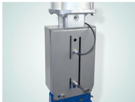
Signalisierung der Endlage AUF/ZU über Näherungsinitiatoren, Verdrahtung in Klemmkästen möglich, ATEX und ASi-Bus Varianten auf Anfrage.
