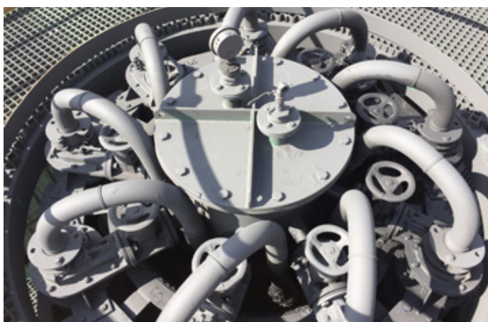
Image : vannes à pincement manuelles à corps en polyamide PVEG50M dans un hydrocyclone à la mine de Kara Mine, TMM, en Tasmanie (Australie).
